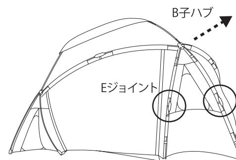
(7) パネル用フレームを連結し、当面にあるスリーブに通します。
