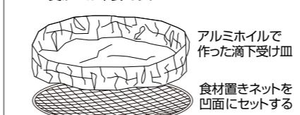
●食材置きネットの装着は、図の本体ドラム両サイドと奥の切り欠きに差し込んでください。食材に合った高さで使用してください。
