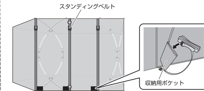
※撤収する際は、ペグを抜く前にすべてのスタンディングベルトのバックルを留め直してください。
