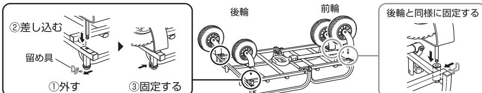
※前輪・後輪の着脱後は、留め具を必ず本体に取り付けてください。(紛失の原因)
