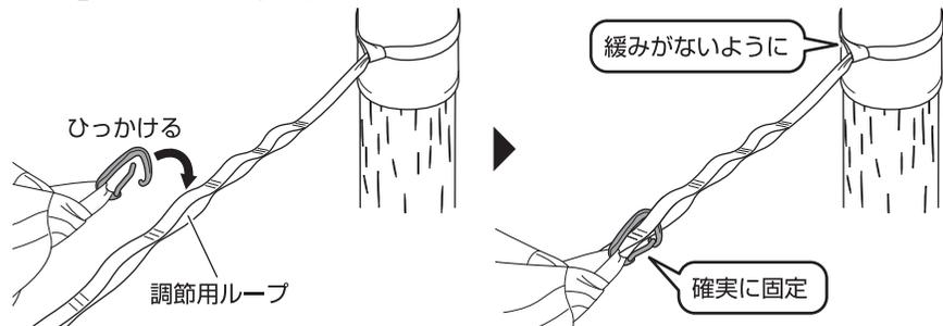
※カラビナを取り付ける位置によって、ベルトの長さを調節できます。
