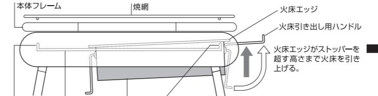
●火床引き出し用ハンドルは燃料の燃焼で大変熱くなっています。ハンドル操作時には、ヤケド等のケガを防ぐために、必ず革手袋を着用してください。決して素手でハンドルに触れないよう注意してください。
