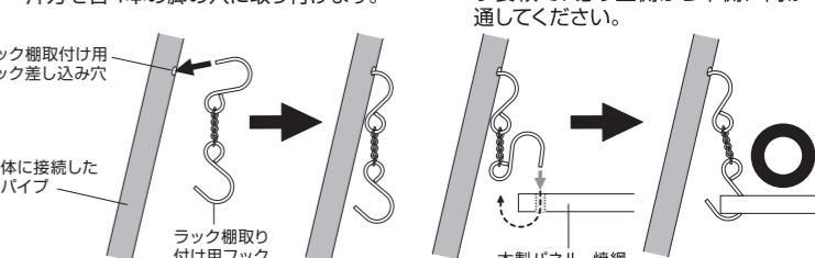
② 木製パネルの四隅の穴(焼網の場合は四隅の隙間)に片方のフックを、図に示す要領で、必ず上側から下側に向けて通してください。
