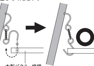
●木製パネル・焼網共フックを下側から上に向けて通すとラック棚が簡単に外れ、載せている物が落して器具の損傷・ケガや事故につながる恐れがあるため大変危険です。
