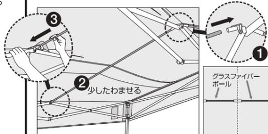
屋根フレーム中央のジョイントにグラスファイバーポール(2本)を差込みます。まず、①天井側のジョイントに差込み、②ポールを少したわませながら、③軒側のジョイントに差込みます。
