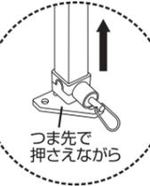
脚フレームを伸ばします。写真のように下段脚の先端をつま先で押さながら上方へスライドさせ、「カチッ」と音がするまで確実に引き上げ固定してください。
