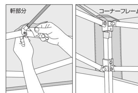
生地の内側に付いているベルクロテープを各々のフレームに巻き付け、生地とフレームを固定してください。
