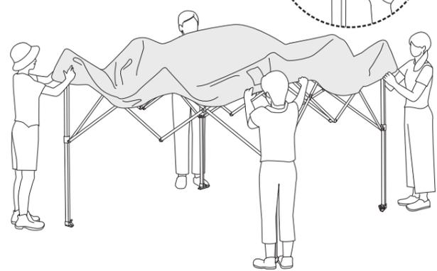
生地とフレームの四隅がきっちり合うように位置を調整し、生地をかぶせ、脚フレームを完全に広げ固定します。
