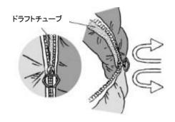
ジッパー部分にドラフトチューブを設け、冷気の流出を防ぐエアガードシステムを採用。
