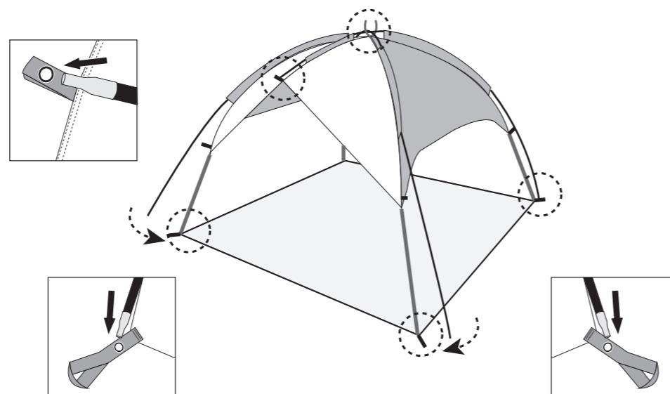
3)側面にあるプラフックをメインフレームに引っ掛け固定してください。
